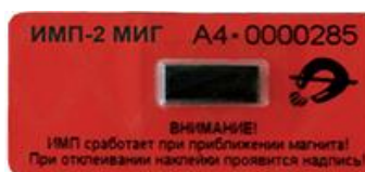
Рисунок 2 - Вид поврежденной пломбы
