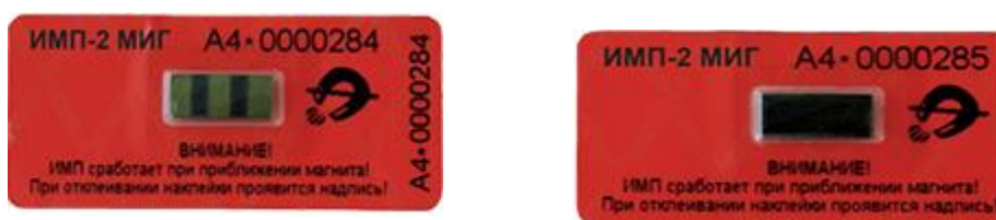
Рисунок 1 - Вид неповрежденной пломбы и пломбы после воздействия на неё магнитом
