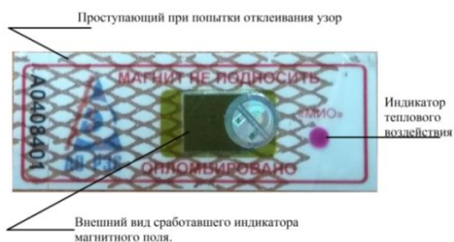
Рисунок 6 - Вид поврежденной пломбы
