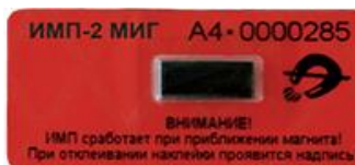
Рисунок 2 - Вид поврежденной пломбы
